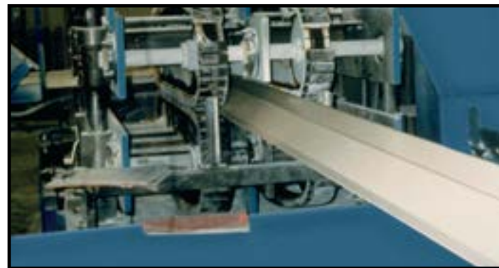
Un perfil Dynaform completo sale del proceso de pultrusión.
